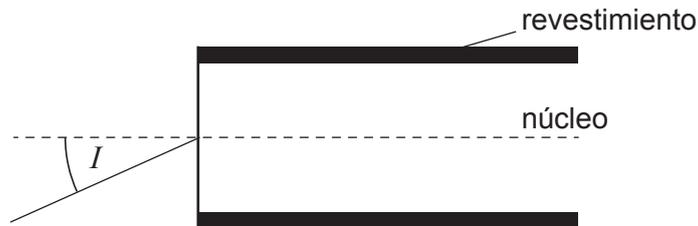
(i) Determine el máximo ángulo de incidencia  $I$  que puede formar este rayo en el aire para que se produzca una reflexión total interna en la frontera núcleo-revestimiento.
